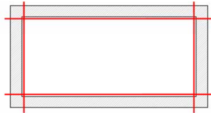
Figura 237: messa in opera di catene perimetrali
